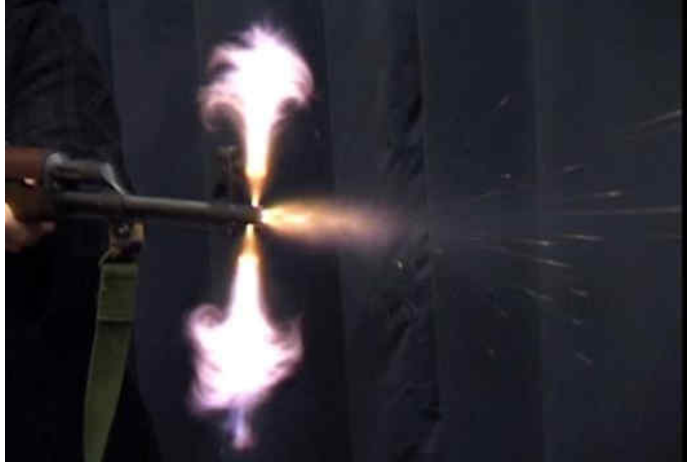
Aseen sysäyksen vahvistaja suuntaa ruudin palokaasuja sysäyksen vahvistajan mallista riippuen.
